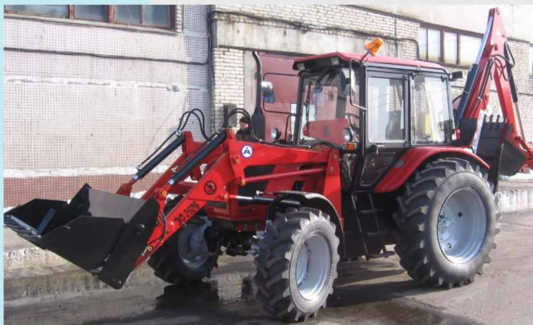
ЭО-2626 с двухчелюстным ковшом и грузовыми вилами
